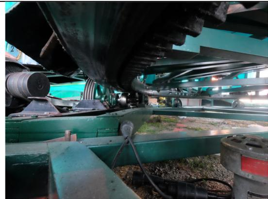
Das Zahnrad auf der Achse des Antriebsmotors greift von unten in die Zahnleiste ein. (RR)
