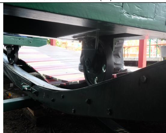
Die äußeren Räder laufen auf der wellenförmig gekrümmten äußeren Kreisbahn auf einem mit Metallblech verstärktem Holzprofil (RR)
